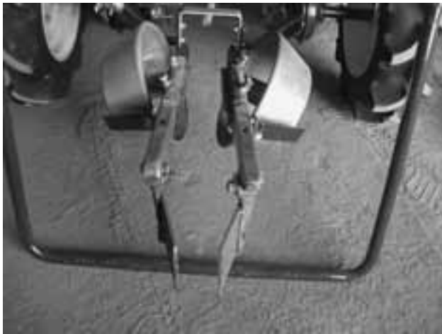
移植機に加えた改良（鎮圧部分の後部に培土板を増設）
